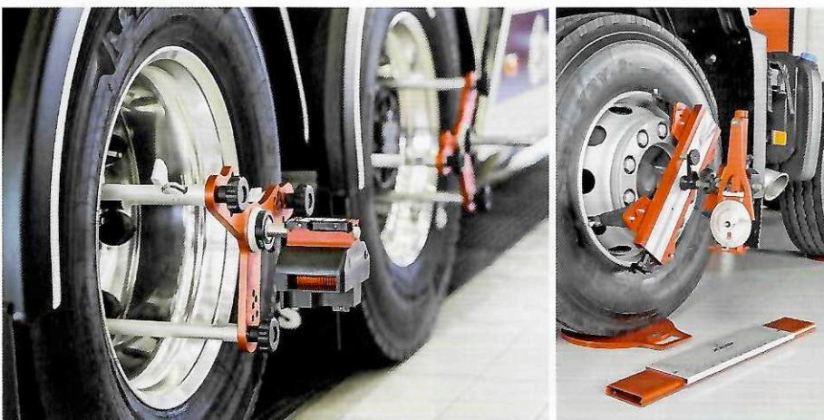
Die beiden Laser-Achsmessgeräte von Josam. Bild links: Der „i-track-II“ wurde für die schnelle Messung optimiert und arbeitet mit einem rotierenden Laser. Bild rechts: Den „laser-AM“ gibt es wahlweise mit elektronischem oder mechanischem Winkelmessgerät.
