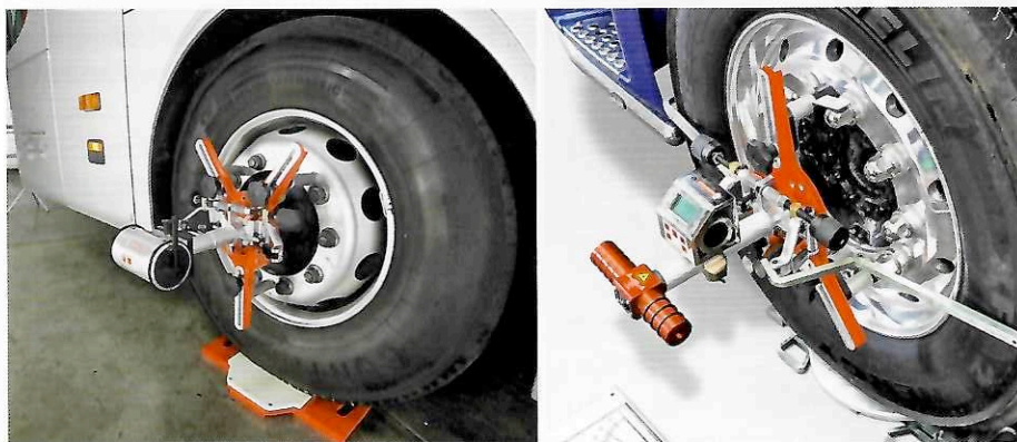
Bild links: Das softwaregesteuerte System „Axis4000“ von Haweka ermittelt die Werte automatisch mit der Kamera und bildet sie am PC ab. Bild rechts: Der um 360 Grad drehbare Lasermesskopf der „Axis500“ von Haweka mit Inklinometer.
