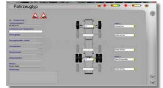
Von der Fahrzeugübersicht aus werden alle Messungen gestartet. Die Messergebnisse aller Fahrzeugachsen werden in einer Gesamtdarstellung aufgeführt.
